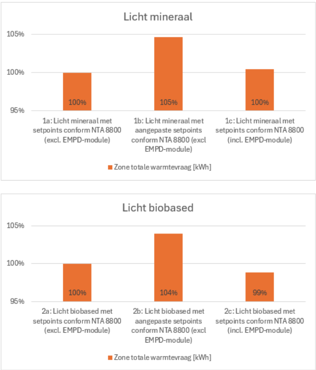
Figuur 35: Resultaten EnergyPlus simulaties voor onderzoek impact hygrische eigenschappen op jaarlijks energiegebruik
