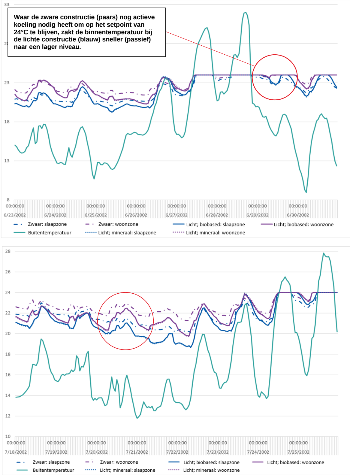
Figuur 11: Temperatuurverloop binnen de ruimte met actieve koeling
