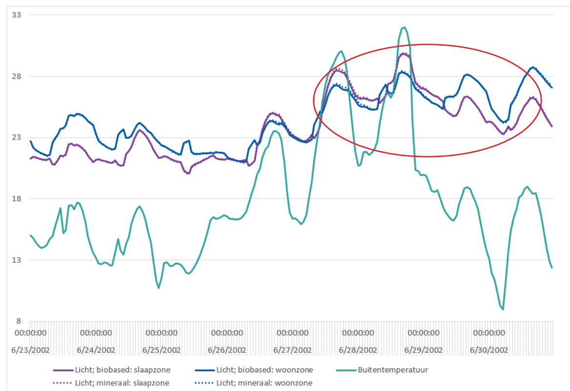
Figuur 12: Temperatuurverloop binnen de ruimte zonder actieve koeling, laatste week van juni.
