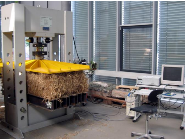
Figuur 2: Proefopstelling met meetinrichting voor bepalen specificaties strobalen [7].
