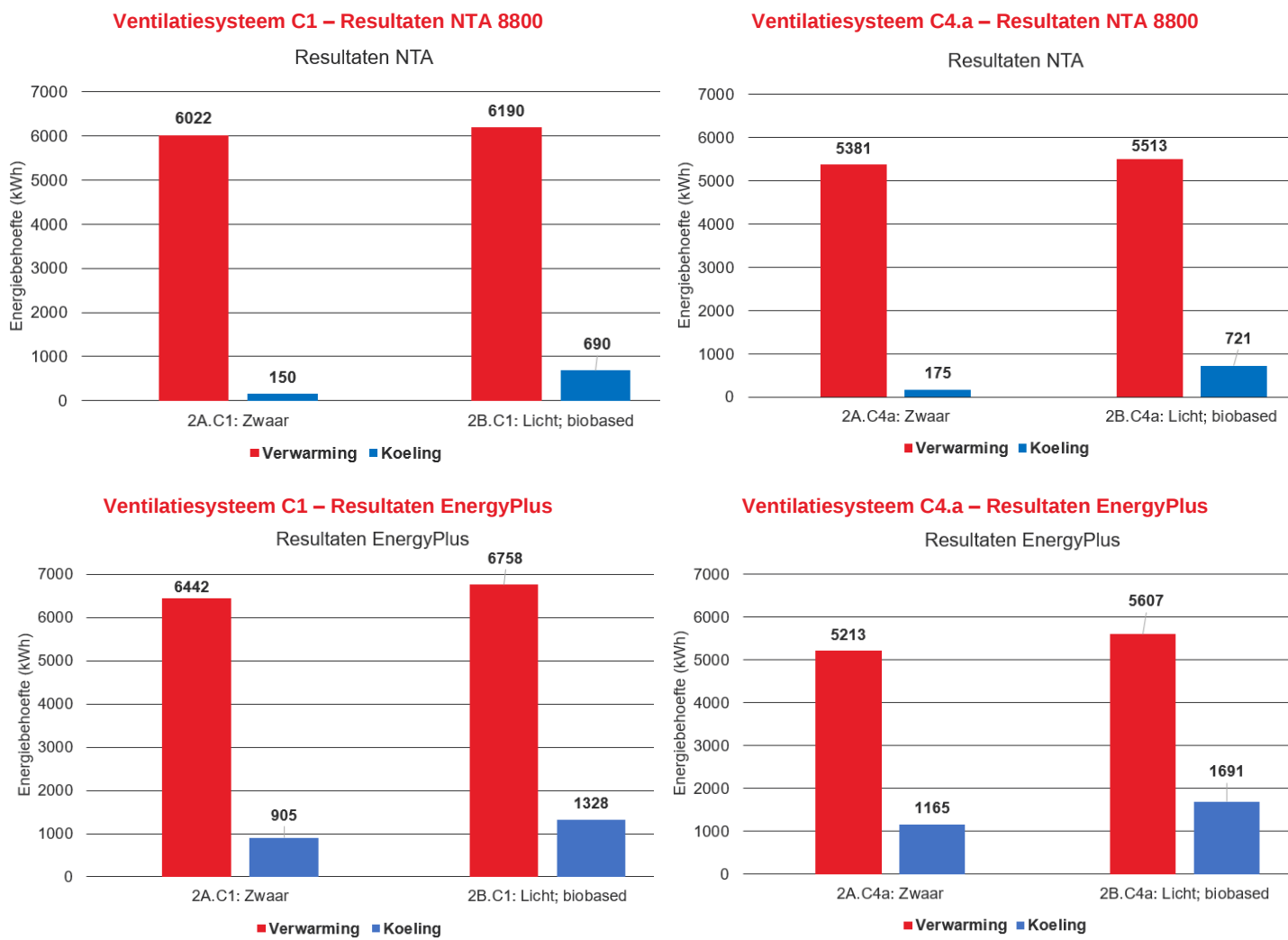
Figuur 14: Vergelijking energiebehoefteresultaten uit NTA en EnergyPlus voor woning 10
